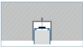
Das PrimoTek Nivellierprofil wird in die vorbereiteten Schraublöcher montiert. Mit den Stellschrauben können das Niveau angepasst und kleinere Unebenheiten ausgeglichen werden. Beachten Sie, dass noch 2–3 mm Gips aufgetragen wird.
