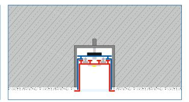
Ansch Abschluss der Malerarbeiten können die Aluminium-Montageprofile LOKOM oder LARKO einfach per Klick in das PrimoTek Nivellierprofil montiert werden. Der Kragen am Profil bildet einen sauberen Abschluss.
