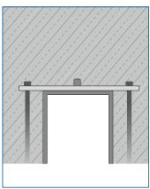
Beim Ausschalen der Decke wird die Grundplatte entfernt. Der Einlegekanal muss gereinigt werden.
